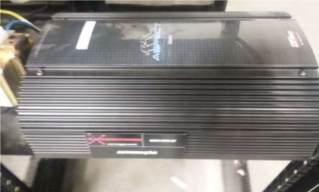
Figura 8.3.1 – Unidade Gerenciadora de automação Modelo Matrix Aspect
