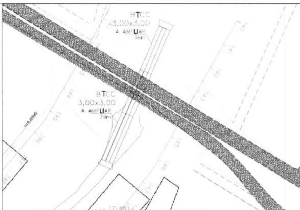
Figura 5- Detalhe Projeto sem a inclusão da drenagem da rotatória.
