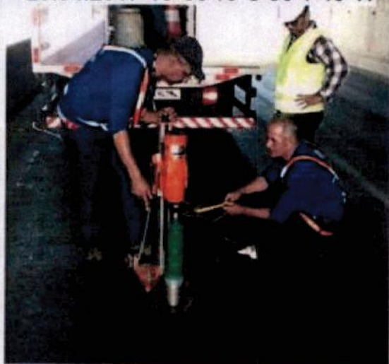
FOTO 5 – EXTRATÇÃO DO CORPO DE PROVA.
