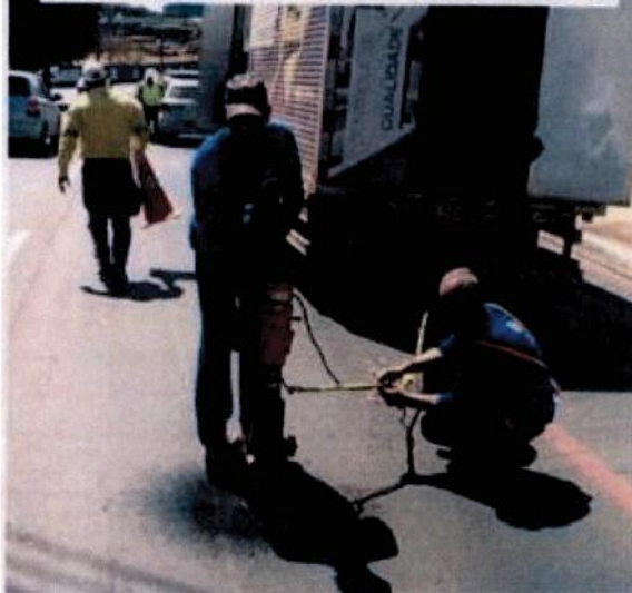
FOTO 6 – EXTRATÇÃO DO CORPO DE PROVA.
