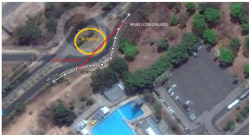
Figura 02 – Em vermelho o segmento previsto inicialmente e em branco o segmento de muro executado.
