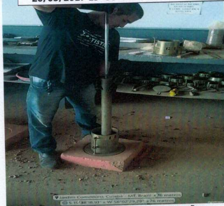
FOTO 56: ENSAIO DE COMPACTAÇÃO.
