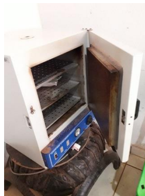
Foto 62 – Equipamento para esterilização enferrujado e em más condições para garantir uma correta esterilização – Unidade de Extensão Barreiro Branco
