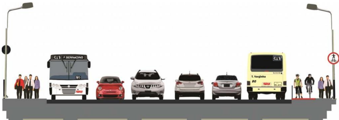
Figura 9: Ponte com ciclovia bidirecional no passeio
