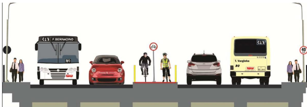
Figura 8: Ponte com ciclovia bidirecional no canteiro central
