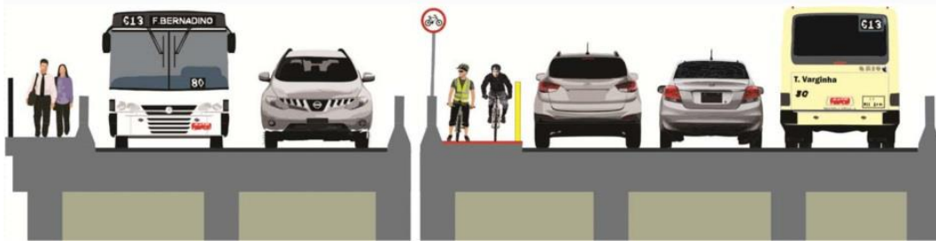
Figura 10: Ponte segregada com ciclovia bidirecional no canteiro central
