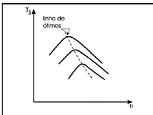
Fig. 5 - Curvas de compactação para diferentes energias de compactação
