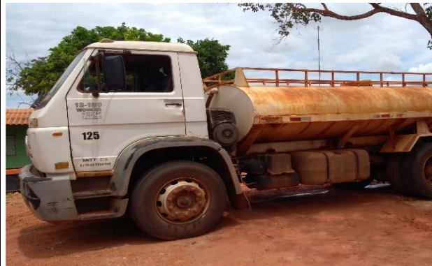
Figura 35 - Caminhão-pipa utilizado para umidificação de vias de acesso interior, no controle de poeira
