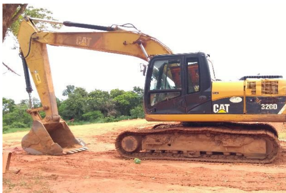
Figura 34 - Escavadeira hidráulica utilizada no manejo de solo para cobertura, resíduos, abertura de valas
