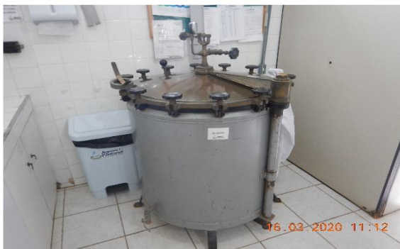
Figura 11 - Autoclave da ETA
