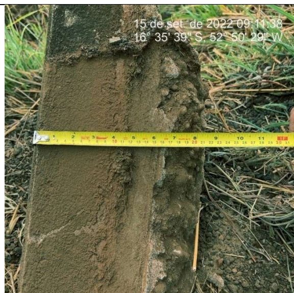
Imagem 3582. Altura inferior e 25cm definida no projeto. Sarjeta com espessura inferior a 10cm definida no projeto.
