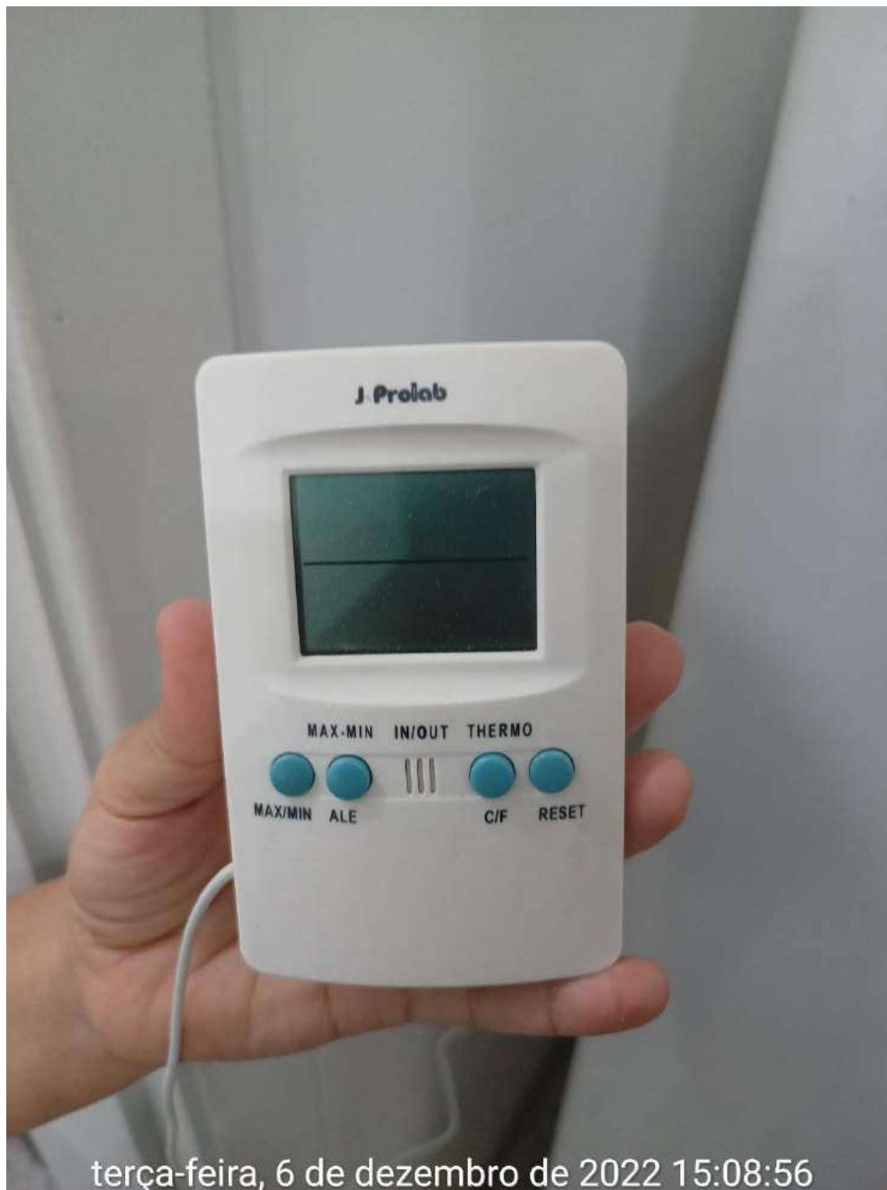
Imagem 46: termo-higrômetro sem registrar a temperatura da geladeira no momento da inspeção
