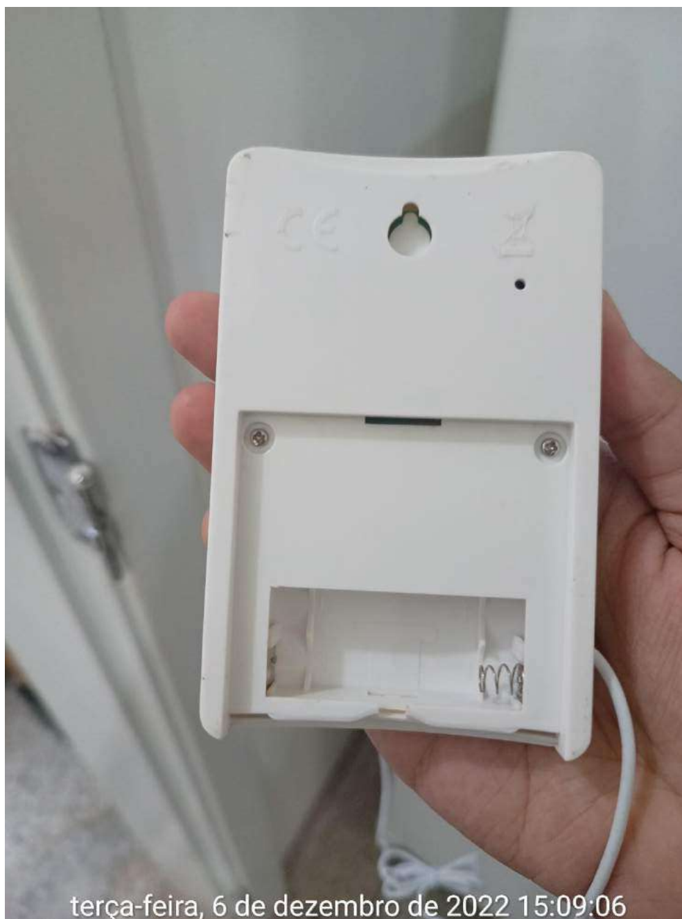
Imagem 47: termo-higrômetro sem registrar a temperatura da geladeira no momento da inspeção, sem pilhas no equipamento
