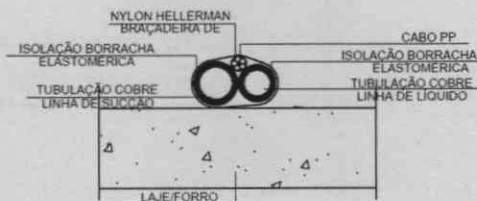
Imagem (01): Pré – instalação, rede frigorígena
